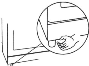
به منظور جلوگیری از پوسیدگی اجاق در مجاورت آب و نیز جهت تراز کردن اجاق گاز مناسب با کف آشپزخانه اجاق مجهز به پایه های تنظیم شونده می باشد جهت نصب پایه ها کافیست اجاق گاز را کمی بلند کرده و آنرا نسبت به شبکه گاز بوسیله پیچهای انتهایی پایه تنظیم نمایید.
